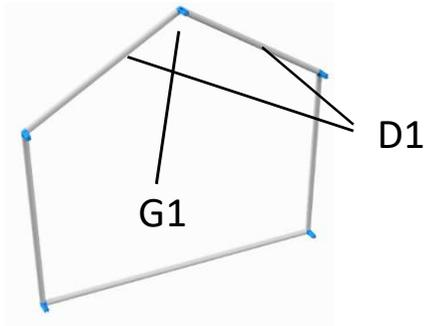
Verbinden Sie die 2 Rohre (D1) mit dem Gerüst aus Schritt 2.
