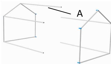
Verbinden Sie die 5 Rohre (A) mit den 5 Rohren (C) und den Winkelstücken.
